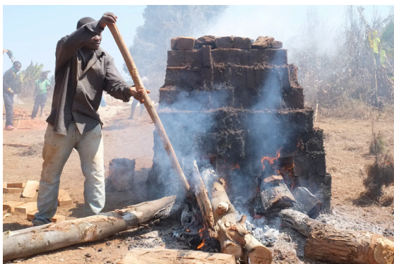
Die Bodenplatten werden gebrannt.
