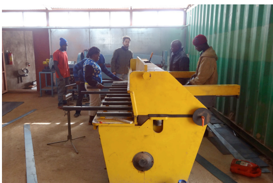
Zuschnitt der Einzelteile der Adobe-Schalung
