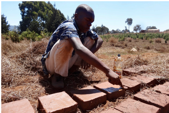
Mit Löffel und Händen wird die Plattenoberfläche poliert
