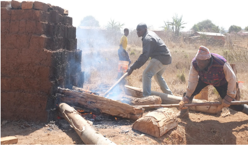
Brennen der Bodenplatten: die Bodenplatten werden zu einem Ofen aufgestapelt, die Fugen mit Lehm abgedichtet. Während einem ganzen Tag wird der Ofen mit Holz befeuert.
