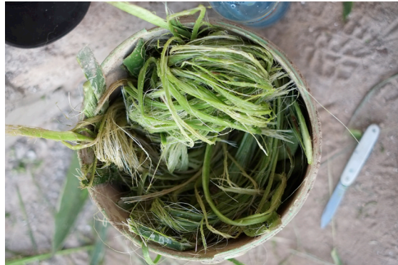
Sisalfasern als möglicher Zuschlag in den Adobesteinen.
