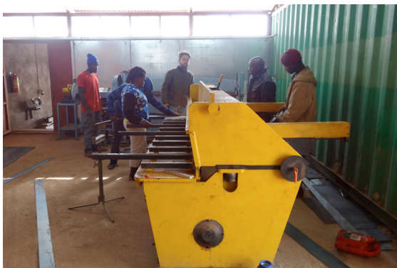
Zuschnitt der Einzelteile der Adobe-Schalung
