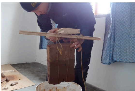
Drip-Test mit Adobe Brick von der Lehmgrube Kikurue
