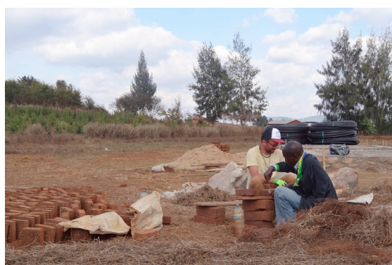
Philipp und Villager am polieren der Bodenplatten
