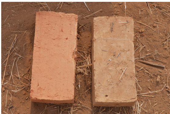
Vergleich eines gebrannten (links) und ungebrannten (rechts) Steins.
