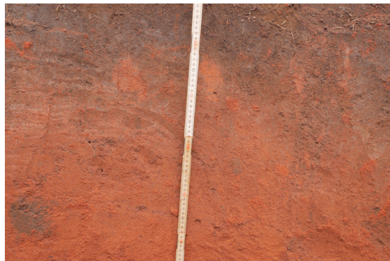
Die Farbe des Lehms für den Mörtel ändert sich mit zunehmender Tiefe
