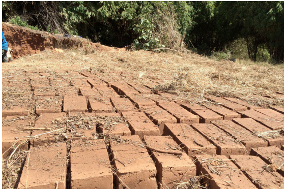
fertige Adobe Ziegel mit unserem Format (leider zu wenig abgedeckt)
