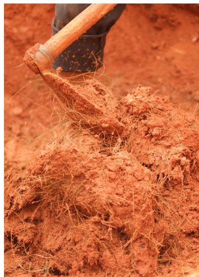
links: Abb.36, Trockenschwindmass von Lehmmörtel bei Faserzugabe rechts: Beimischen von Piniennadeln zu Lehm
