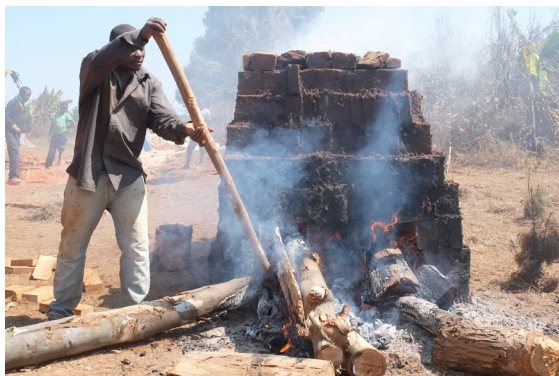
Die Bodenplatten werden gebrannt.
