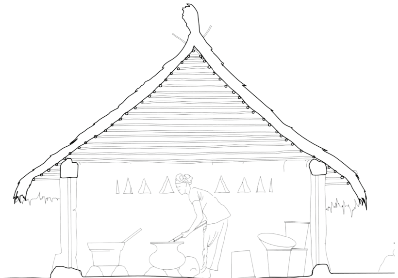
Abb.39 Querschnitt durch ein Haus mit einer Lehm-schwelle
