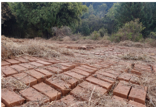
Steine beim Trocknen, leider auf abschüssigem Terrain
