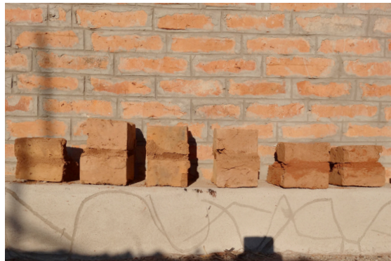
Verschiedene Mörtelzusammensetzungen im Test
