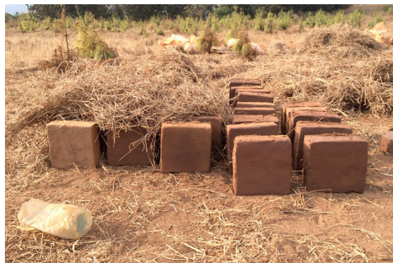
Die polierten Bodenplatten werden zur weiteren Trocknung aufgestellt.
